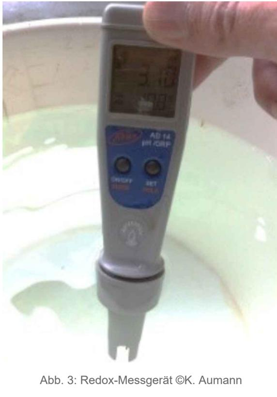
Abb. 3: Redox-Messgerät ©K. Aumann
